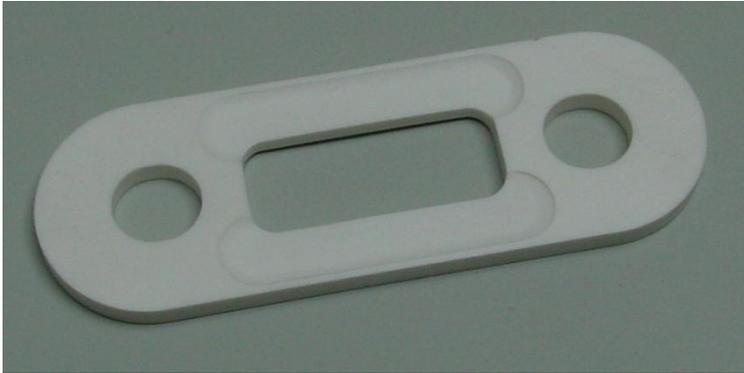
Sieb für Kalkschlemme. Keramikplättchen werden durch Unterlegscheiben auf Distanz gebracht. Der Abstand zwischen den Plättchen bzw. die Dicke der Unterlegscheiben bestimmt die Filterungsgrad.
