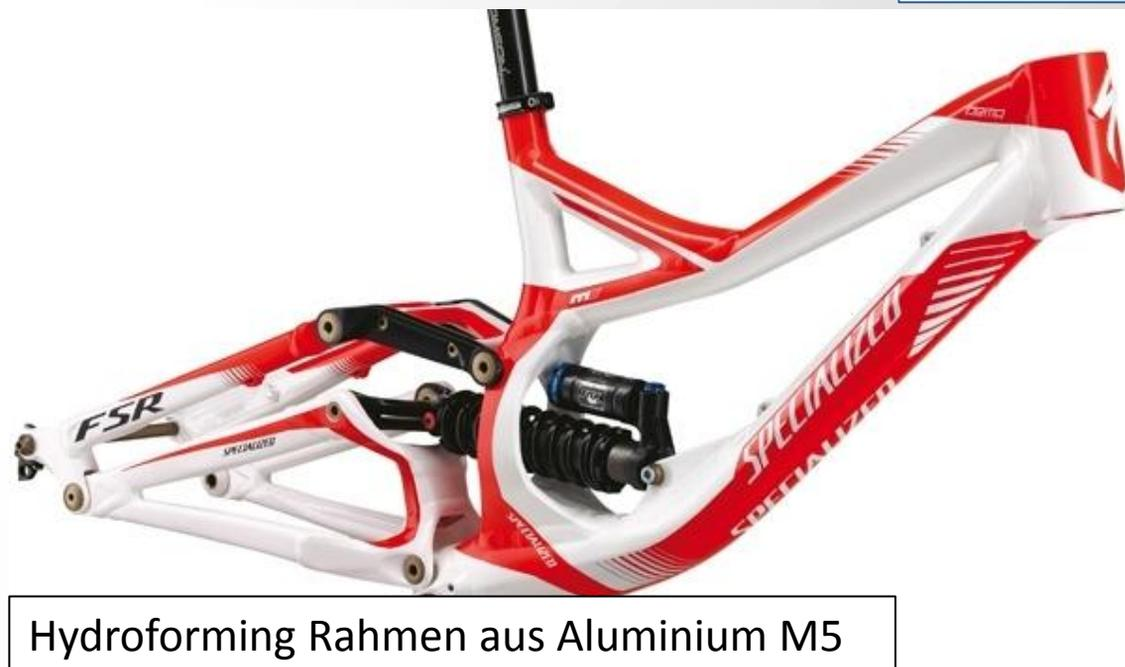
Hydroforming Rahmen aus Aluminium M5
