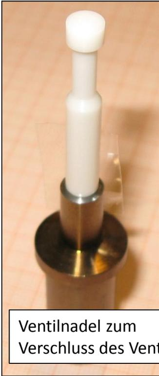
Ventilnadel zum Verschluss des Ventils
