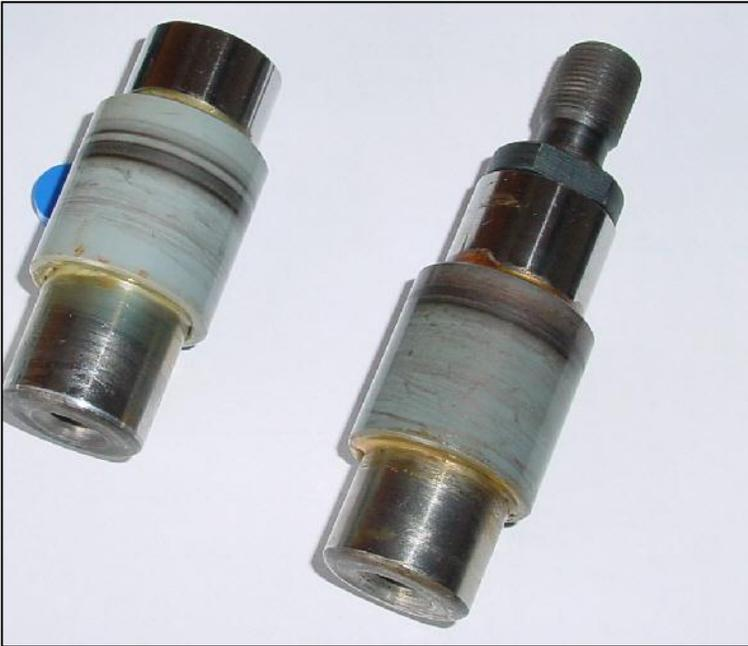
Einfache Bauweise, Keramikbuchse kann auf genormtes Kugellager geklebt werden. Geeignet für Führungsrollen bei heißen und kalten Anwendungen der Draht- und Bandfertigung
